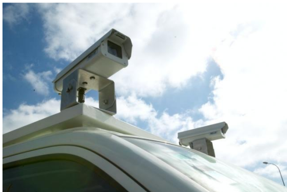
Imagen 3: Cámaras tomando datos del centro de la vía y el arcén
